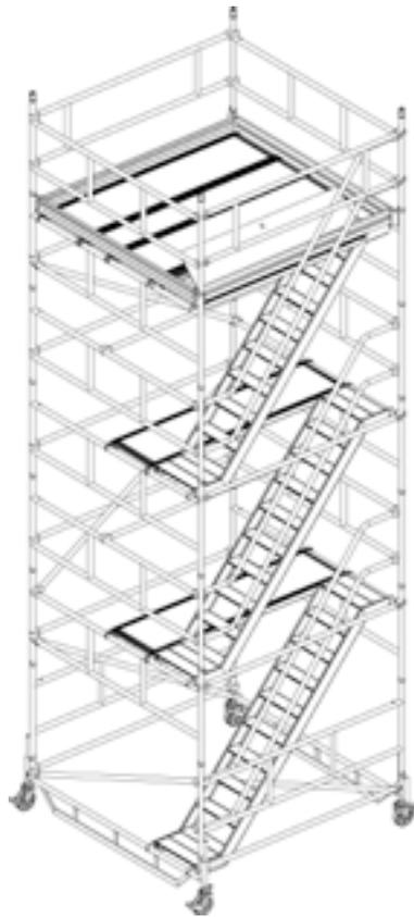
Sistema di accesso mediante comoda scala a rampa
